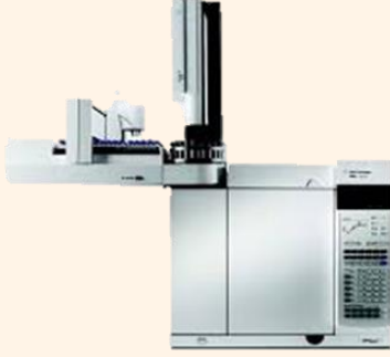
Gaz Kromatografisi-Alev İyonlaşmalı Dedektör (GC-FID)
